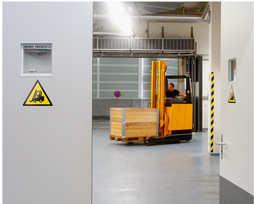
Bild 17 «Warnung vor Flurförderfahrzeugen» an der Türe zu einem Lager
